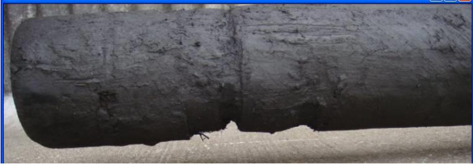
車体前方からの軸と左側摩耗状態
