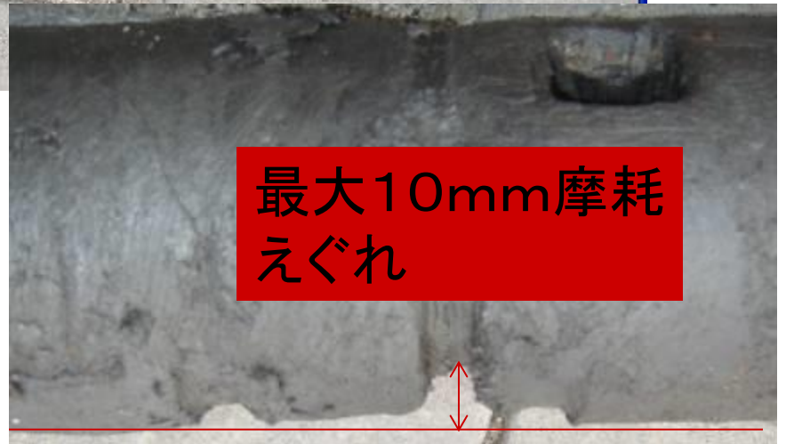
車体後方からの軸と摩耗状態
